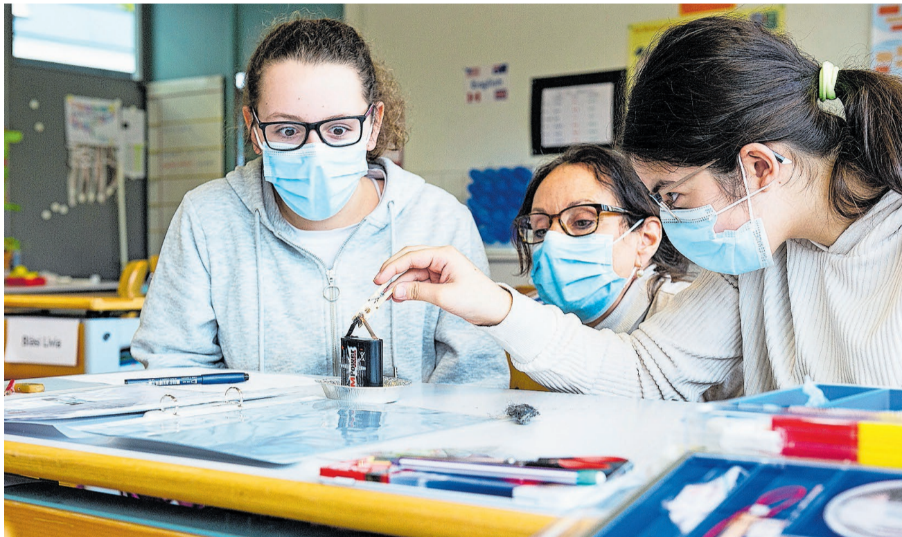
Mit Wäscheklammern halten die Schülerinnen bei diesem Experiment Stahlwolle zwischen die Laschen einer Flachbatterie.
